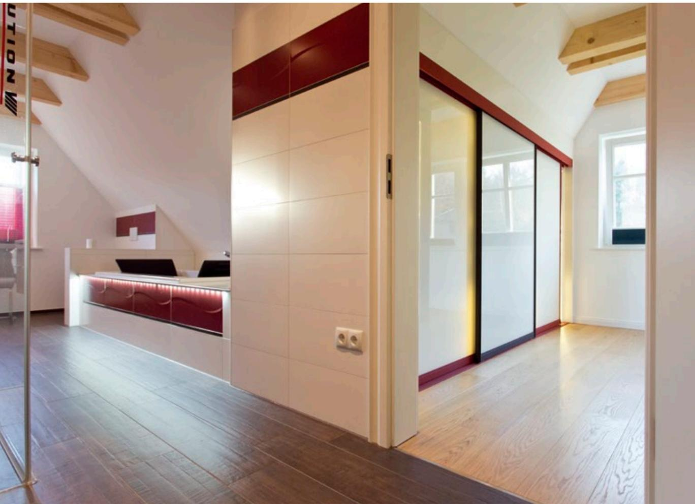
Das nächste Ankleidezimmer wurde mit dem gleichen Schiebetürsystem ausgestattet. Es besteht aus Aluminiumprofilen, welche trotz der enormen Verwindungssteifigkeit angenehm leicht zu bedienen sind.
